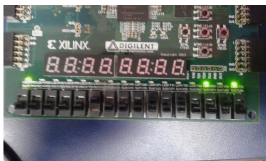
Figura 17. Ejecución de hardware para la prueba del comparador (argumentos: a=5, b=2).
