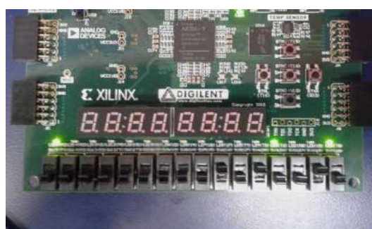
Figura 19. Ejecución de hardware para la prueba de raíz cuadrada (argumento: num=82).
