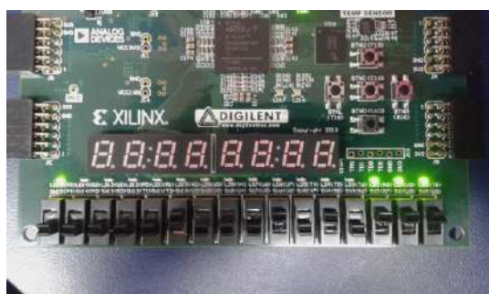
Figura 18. Ejecución de hardware para la prueba del comparador (argumentos: a=5, b=7).
